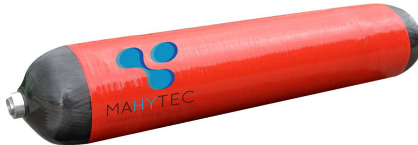
Figure 2 – Réservoir composite MAHYTEC pour le stockage et le transport d'hydrogène (diam.0,49 m, long. 3,07 m, capacité 9,7 kg (300 l à 500 bars))
