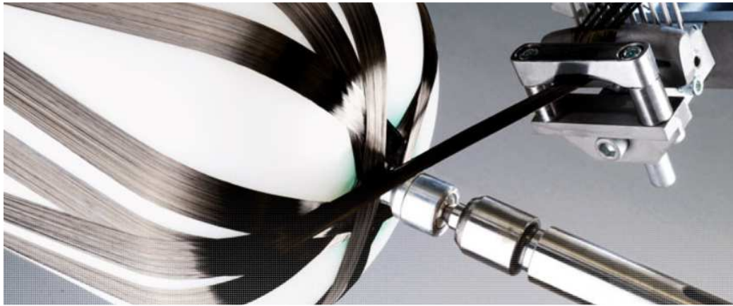
Figure 4 - L'enroulement filamentaire (document Xperion)
