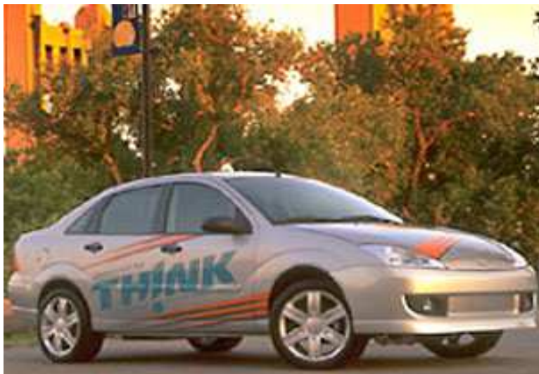
Figure 3 – Le prototype THINK FC5 à méthanol (2001)
