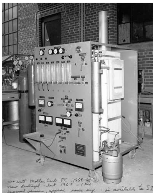
Figure 1 - Module MCFC de 100We fabriqué par Texas Instruments (1964)
