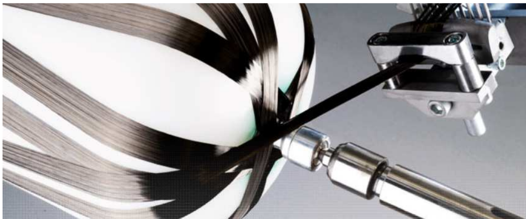
Figure 4 - L'enroulement filamentaire (document Xperion)
