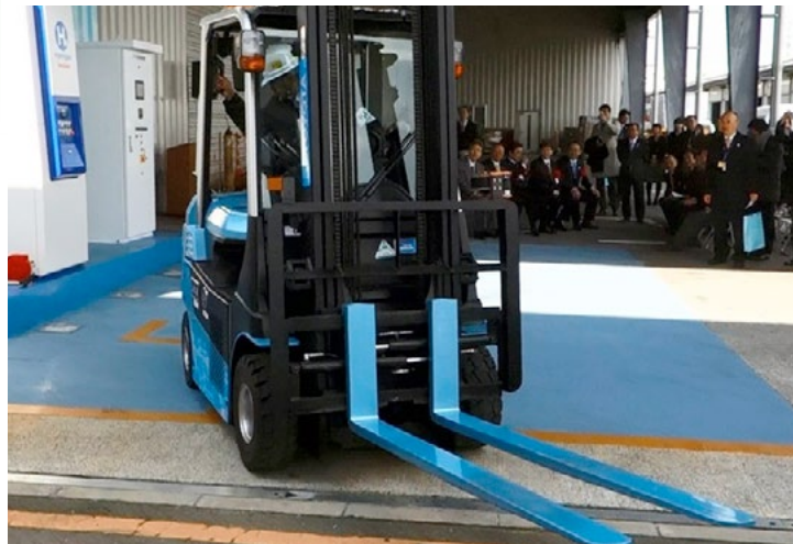
Un chariot élévateur à pile à combustible, avec une station de remplissage en arrière plan, à l'aéroport International du Kansai
