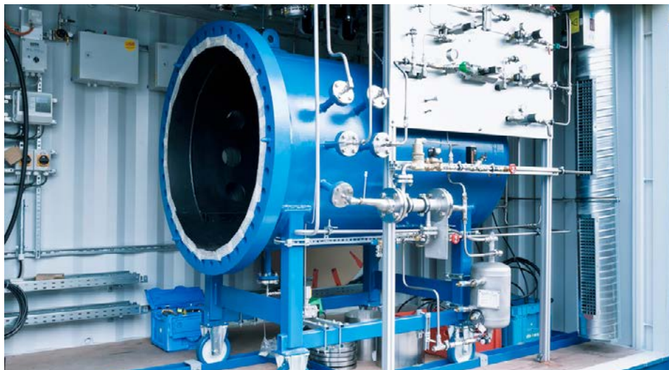
L'électrolyseur SOEC développé dans le cadre du projet
